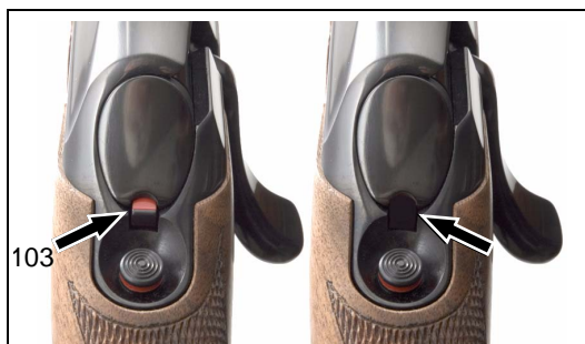
Fig. 7. Spännindikator 103 för slutstycke (vänster: spänd, höger ej spänd)
